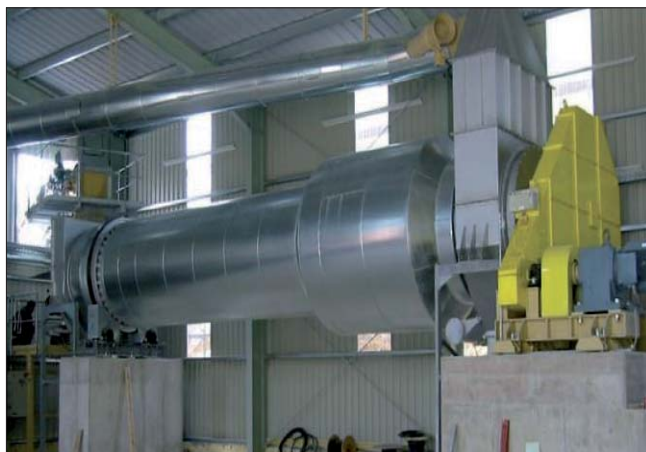
Рис. 2. Обеспыливающая сушилка для известняка
