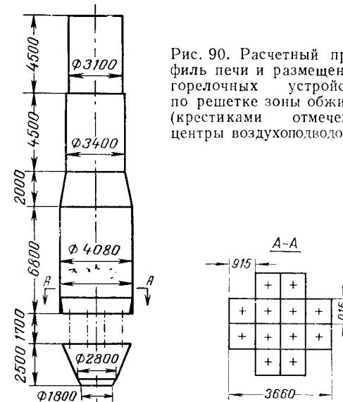
Рис. 90. Расчетный профиль печи и размещение горелочных устройств по решетке зоны обжига (крестиками отмечены центры воздухоподводов).
